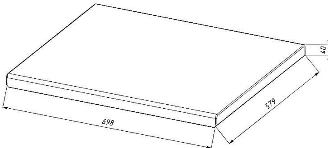
Рисунок 4 – Столешница для шкафа модульного REL.01.0702.05.
