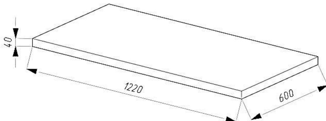
Рисунок 2 – Столешница для стола-верстака среднего REL.01.0702.02.
