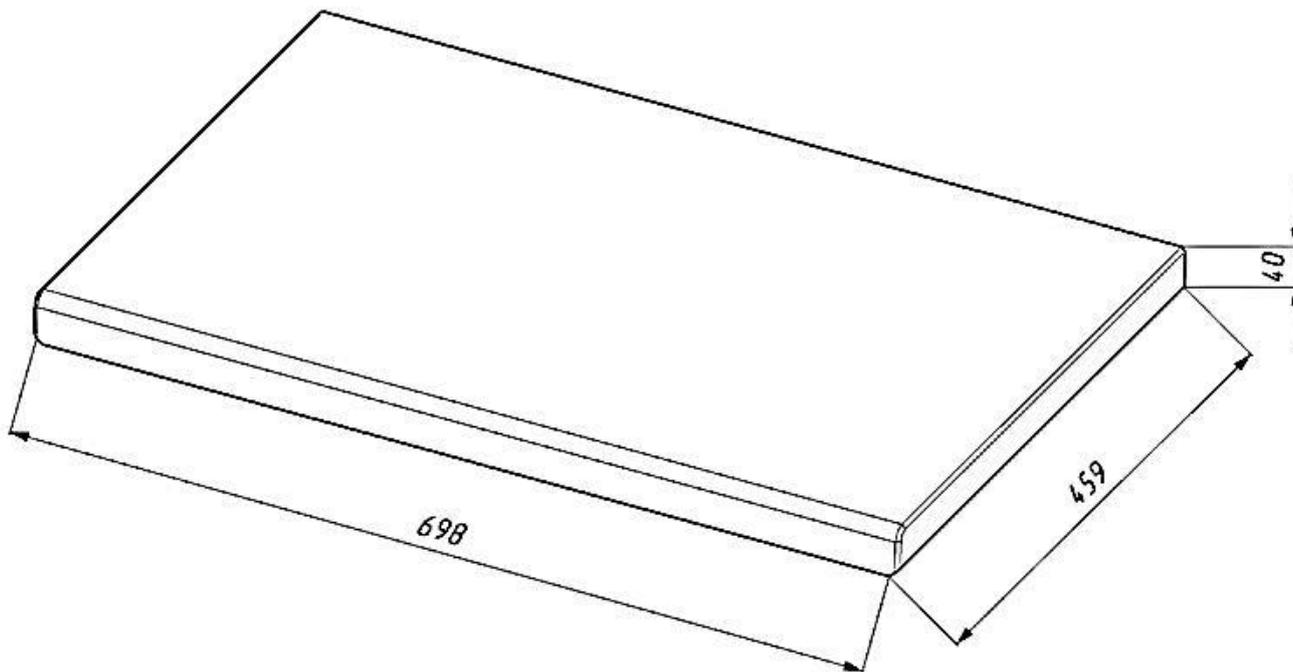
Рисунок 3 – Столешница для шкафа модульного с ящиком REL.01.0702.04.
