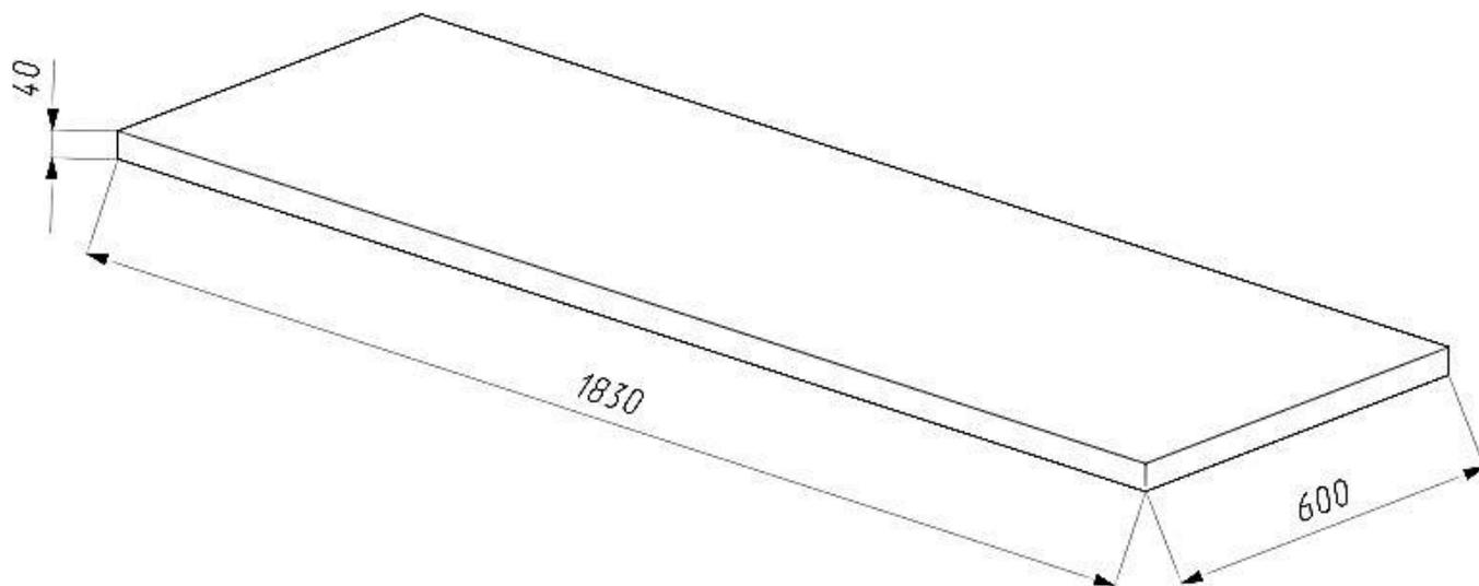
Рисунок 1 – Столешница для стола-верстака большого REL.01.0702.01.
